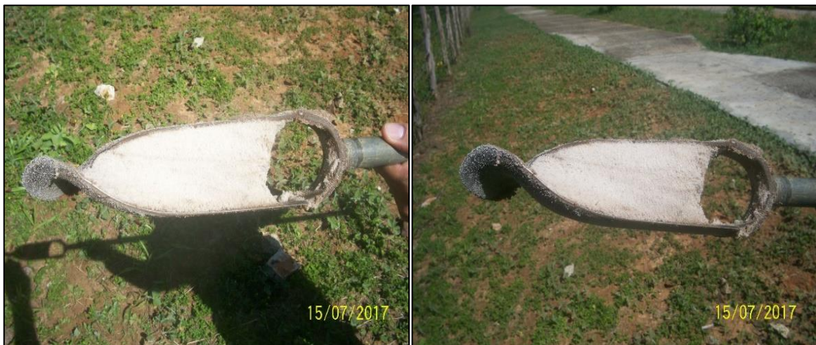
Figura 25 - Tradagem realizada em campo – Neossolo Quartzarênico
